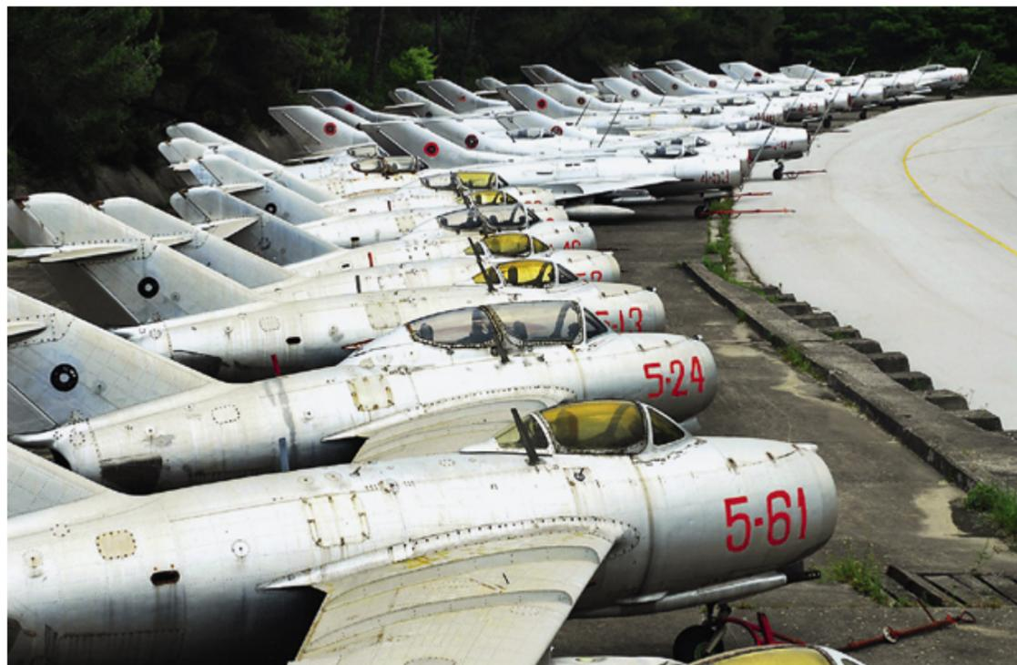
*Истребители МиГ-15 бис с турбореактивным двигателем ВК-1 стали классикой боевой авиации, проверенной в воздушных сражениях над Северной Кореей и в многочисленных локальных конфликтах второй половины XX века*
