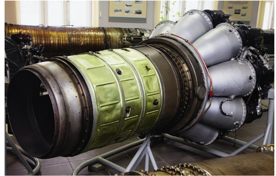
*Турбореактивный двигатель РД-45 в экспозиции музея Уфимского моторостроительного производственного объединения. Этот «боец» вдоволь нюхнул порошу над Северной Кореей!*
