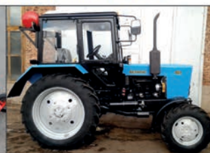
Тракторы «Беларус 82.1» на газодизельном топливе
