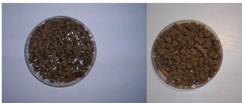
Evolución de los pellets de Hoja de Olivo no tratados de forma térmica previamente y expuestos a la intemperie.
