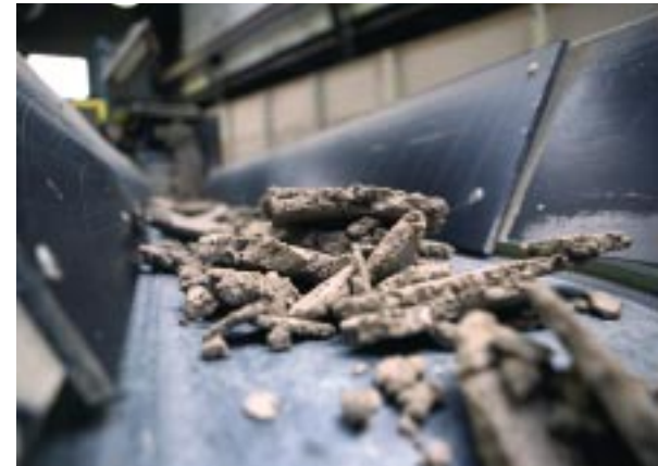
Det tar tre dygn att bränna de klassiska bruna klinkerplattorna från CC Höganäs. Temperaturskillnaderna i ugnen skapar de unika färgskiftningarna.
