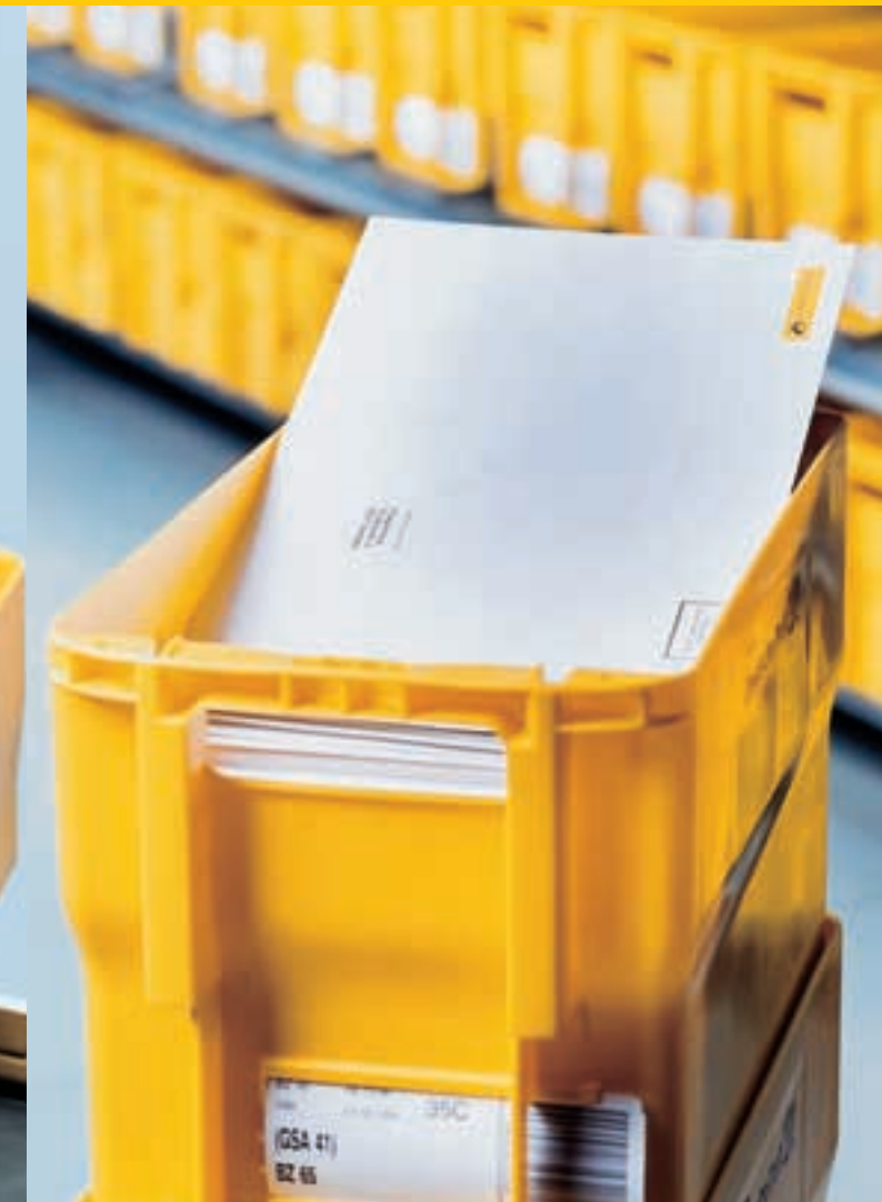
Abb. 2: Groß- und Maxi-briefsendungen im Behälter der Größe 2; Kennzeichnung an der Frontseite durch Infoträger
