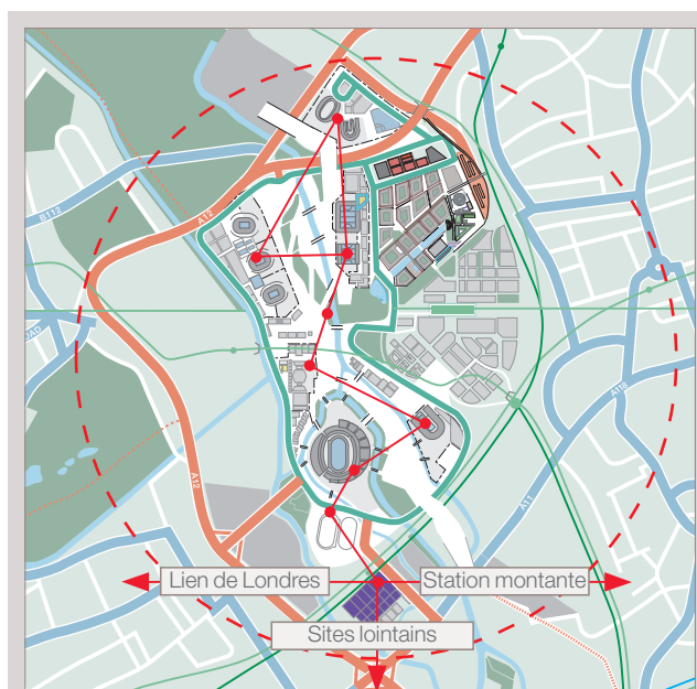
Schéma 7 Les grandes lignes du réseau optique au parc olympique.
