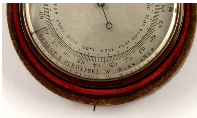
Ryc. 10, 11 Barometr kieszonkowy, Berent i Plewiński, ok. 1920, wł. Muzeum UJ, fot. G. Zygier
