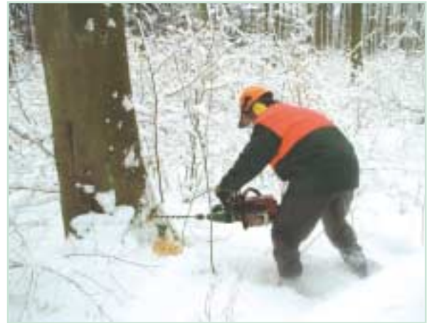
Sobald sich während des Bohrvorganges das helle Bohrmehl in braunes umwandelt ist der Kern erreicht.
