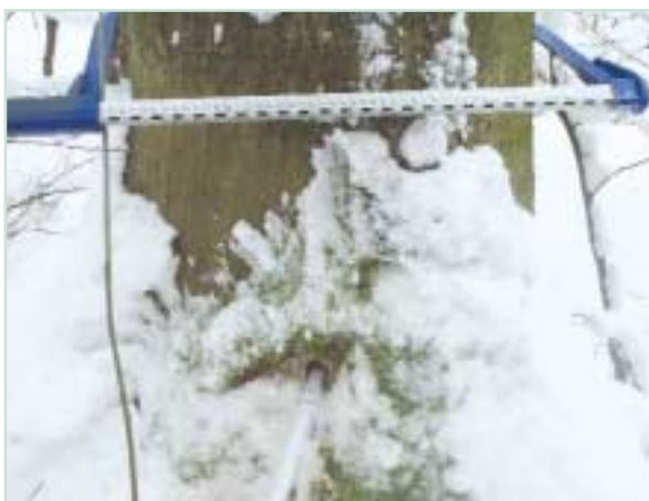
Anhand der Tiefe des Bohrloches u. dem Stammdurchmesser kann das Verhältnis von Stamm- zu Kerndurchmesser ermittelt werden.
