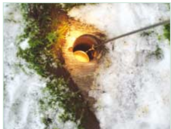
Anhand der Tiefe des Bohrloches u. dem Stammdurchmesser kann das Verhältnis von Stamm- zu Kerndurchmesser ermittelt werden.
