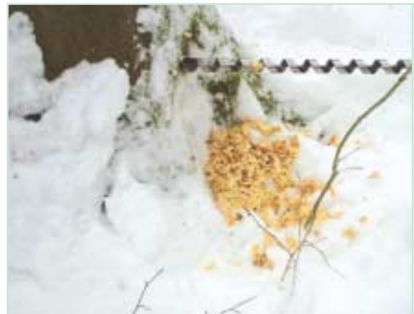
Sobald sich während des Bohrvorganges das helle Bohrmehl in braunes umwandelt ist der Kern erreicht.
