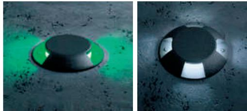
Die Leuchten werden an 230 V angeschlossen. Sie sind mit 12 LED in verschiedenen Farben erhältlich. Das Gehäuse und die Abdeckung ist grau und aus lackiertem, korrosionsbeständigem Aluminium. Der Lichtaustritt erfolgt aus 2 oder 4 Fenstern. Die Boden- Einbaustrahler sind bis max. 1000 kg überrollbar.
