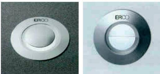
Die erste Leuchte hat eine ringförmige Lichtlenk Optik und eignet sich als fern wirkendes Orientierungslicht. Auch hier ist ein dynamischer Farbwechsel möglich. Der Durchmesser beträgt bei beiden Leuchten 56 mm. Bei der zweiten Leuchte handelt es sich um ein Bodenfluter für Wandmontage. Die untere Hälfte dient mit dem Reflektor als Bodenfluter und die obere Hälfte als Orientierungslicht.
