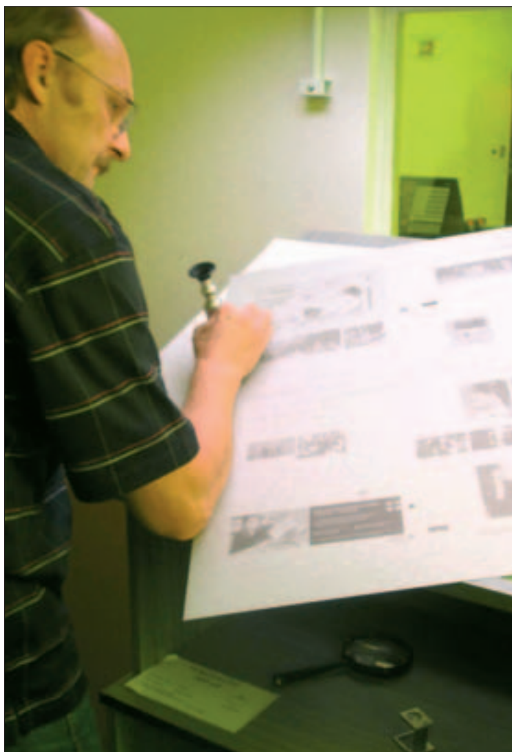
Průběžná kontrola osvitu desek
