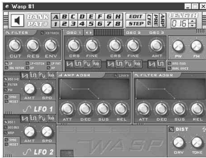
kuva: Orion Pro 2.5 softastudion subtraktiivisen synteesin ohjelmistopohjainen mallinnus WASP, joka on nykyään saatavana myös FL Studioon. WASP perustuu yleiseen kolmen oskillaattorin malliin, joka on tuttu monesta vanhasta jänniteohjatuista analogisyntetisaattorista.
