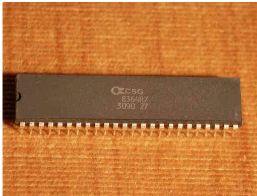
kuva: Commodore Amiga -mallistossa käytetty PAULA-äänipiiri.
