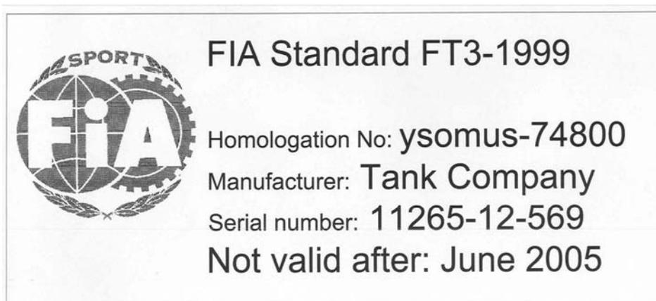
Fig 8. Marquage obligatoire du réservoir- Mandatory bladder marking
