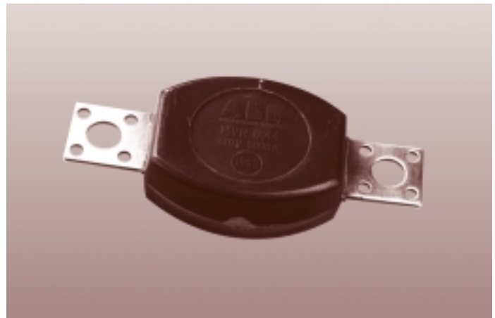
Rysunek 13 Ogranicznik przepięć typu MVR. Używany w układach niskiego napięcia i urządzeniach dla kolejnictwa. Dla zastosowań w układach napięcia zmiennego i stałego. Dostępny dla I_n=5 kA i 10 kA z napięciem U_c=440 V, 660 V i 800 V.
