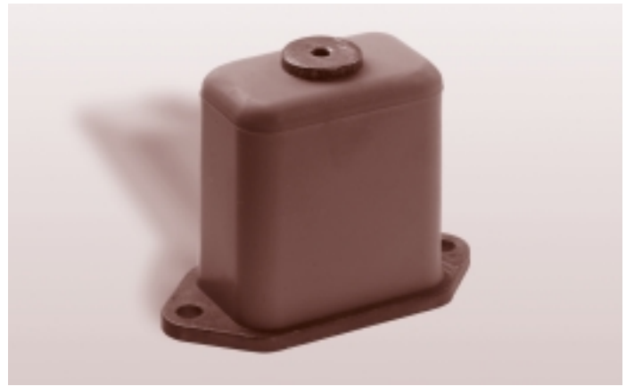
Rysunek 12 Ogranicznik przepięć typu POLIM-R. Bardzo wysoka zdolność pochłaniania energii. Może być używany w sieci napięcia stałego i zmiennego. Typ ten, oprócz innych zastosowań, jest używany w sieciach trakcyjnej prądu stałego. Zakres U_c od 140 V do 1000 V napięcia stałego i od 110 V do 780 V zmiennego. Przebadany zgodnie z klasą prób I i II.
