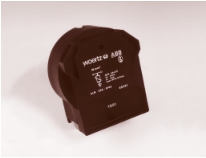
Rysunek 14 Ogranicznik przepięć typu MVR...ZS. Dla układów niskiego napięcia. Wyłącznie dla zastosowań wewnętrznych. Dostosowany do montażu na listwach DIN. I_n=5 kA, U_c= 140V, 250 V i 440 V .
