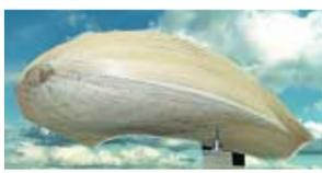
Windkanalmodell eines Hybridluftschiffes
