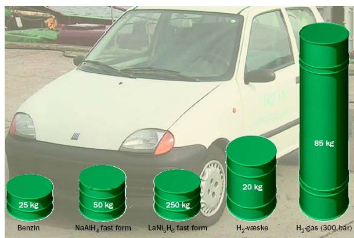
Figur 3.2. Regneeksempel med en mindre bil, der har en benzinøkonomi på 16 km/L og en rækkevidde på 400 km. Det samlede benzinforbrug bliver ca. 25 L svarende til ca. 7 kg hydrogen forbrændt i en forbrændingsmotor med en virkningsgrad på ca. 15 %. Hvis bilen i stedet var udstyret med en brændselscelle, der elektrokemisk kan forene hydrogen og ilt til vand med en virkningsgrad på f.eks. 30%, var det kun nødvendigt med ca. 3,5 kg hydrogen.
