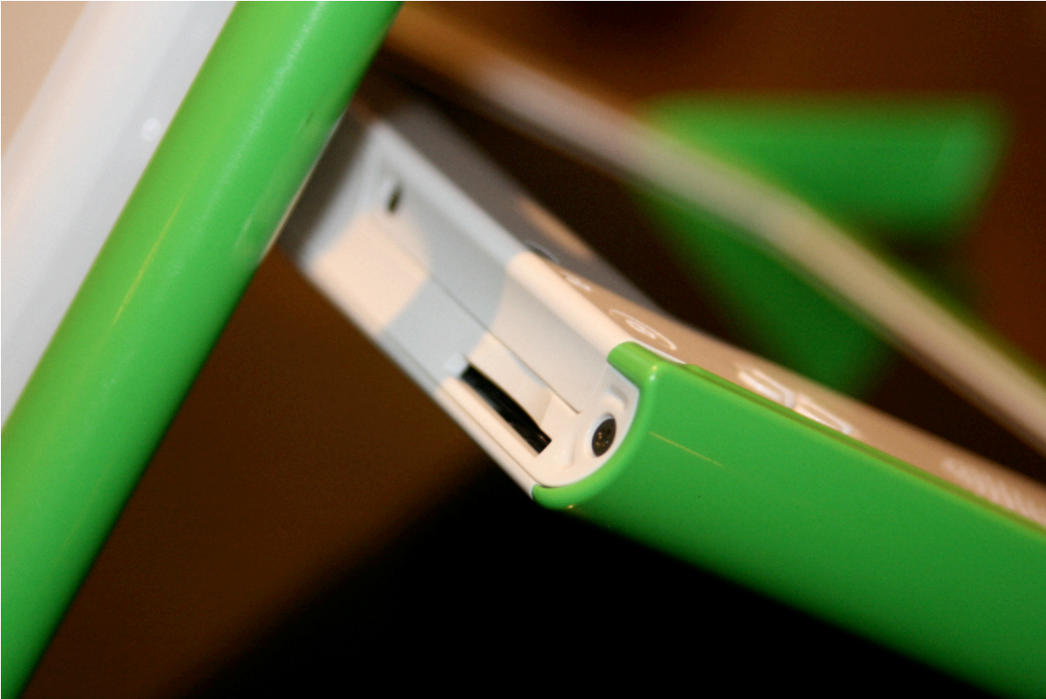
Fig.4. Conector de extensión para Memorias SD en el equipo OLPC.
