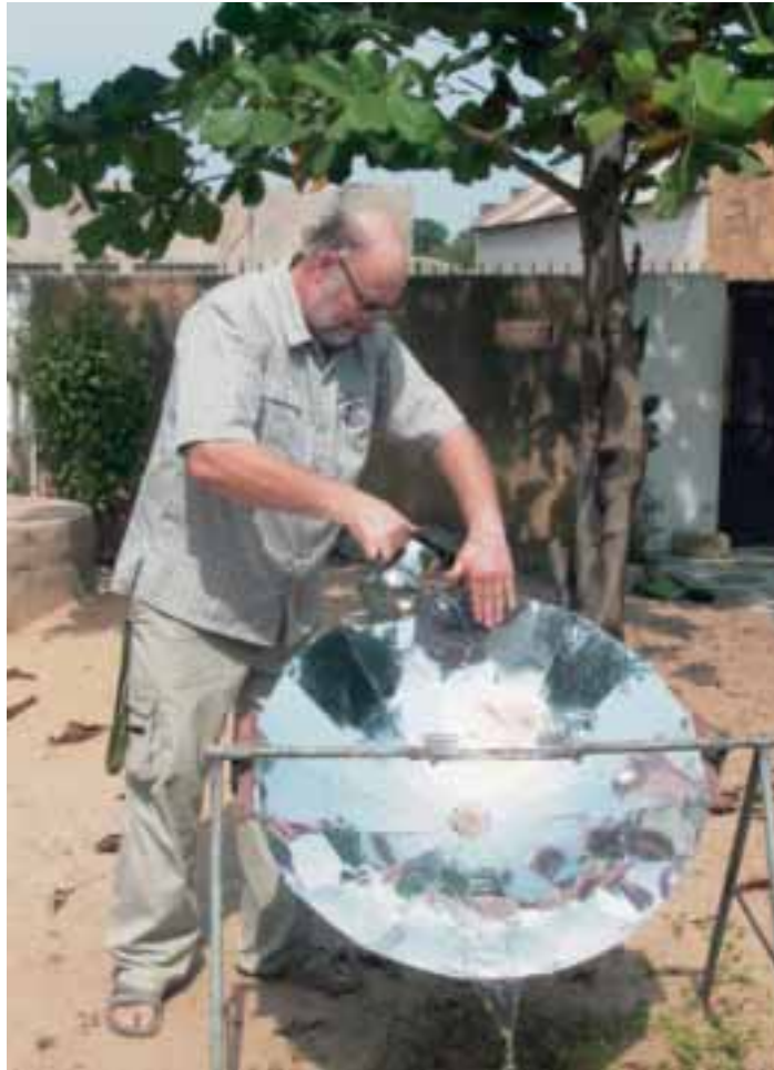
Aurinkokeitin pitää ennen käyttöä huuhtoa kaikkialle tunkeutuvasta hiekasta – Bengt Häggblom työssä.
