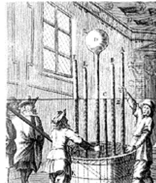
Abb. 4 Die Höhe des Quecksilbers im Experiment ist unabhängig von Form, Neigung und Länge des Rohrs
