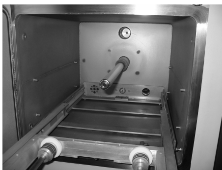
Abb. 11 Plasmareaktor mit Trommelstab
