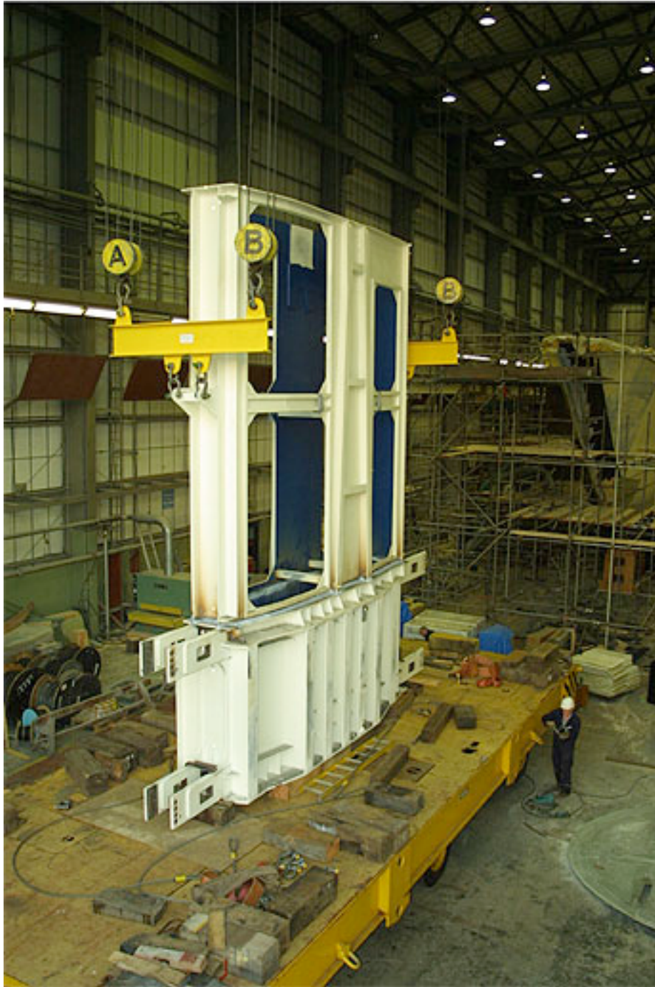
The keel box structure
