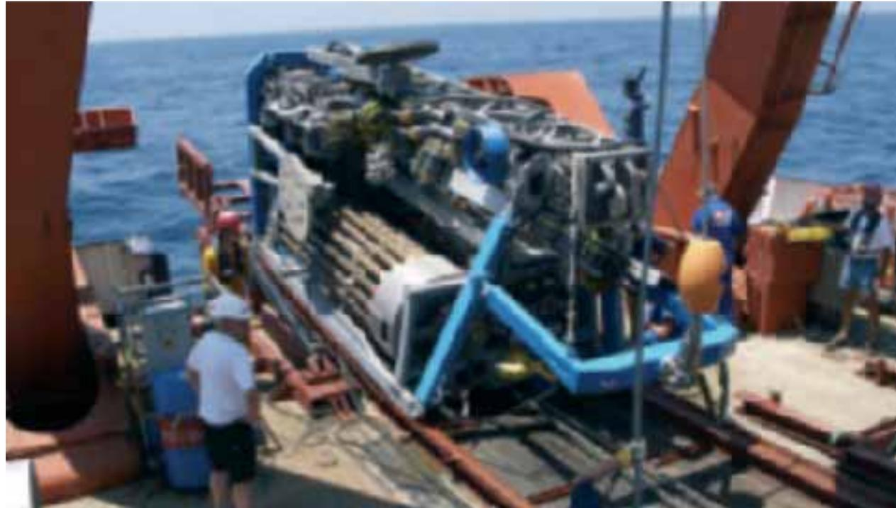
*Sechs Meter hoch und zehn Tonnen schwer ist das vom Bremer DFG-Forschungszentrum „Ozeanränder“ entwickelte Meeresboden-Bohrgerät „MeBo“. Während bislang auf dem Meeresboden lediglich bis 15 Meter Tiefe gebohrt werden konnte, erlaubt das neue Gerät Bohrtiefen bis zu 50 Meter. Seinen ersten Einsatz hatte das „MeBo“ auf einer Meteor-Expedition zwischen den Kanaren und Marokko.*
