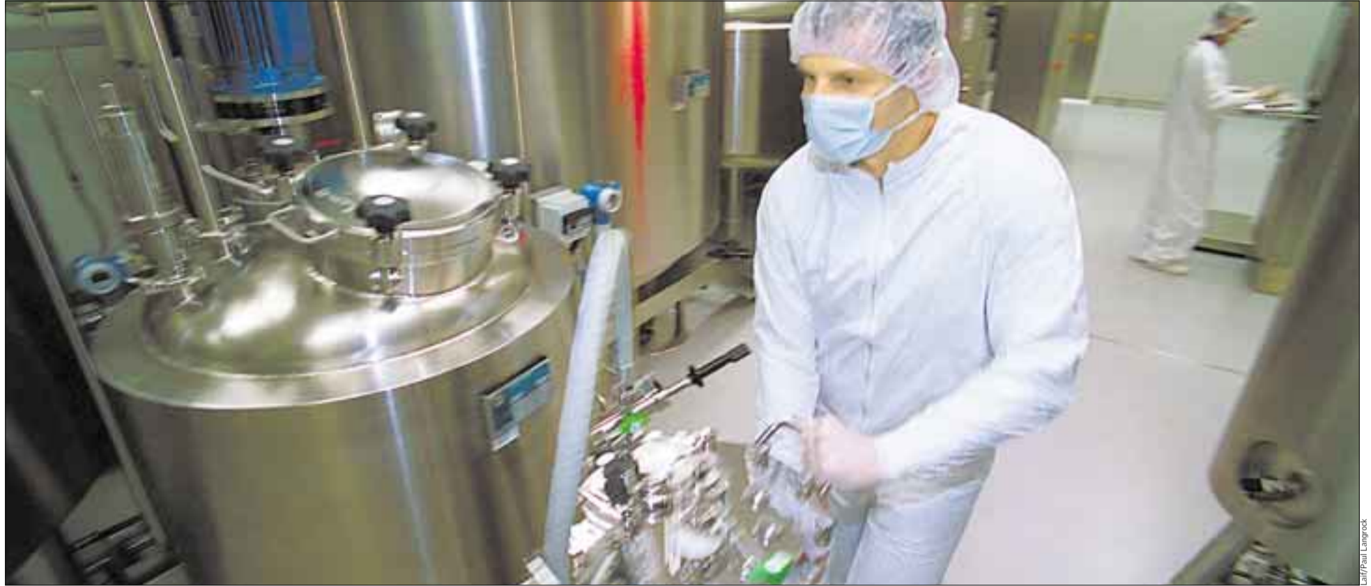
Bei der Herstellung von Biowirkstoffen muss das Reaktionsmilieu sorgfältig stabil gehalten werden. Dabei helfen Pufferlösungen . Sie werden in Tanks gemischt, wie hier bei Bioslect in Teterow
