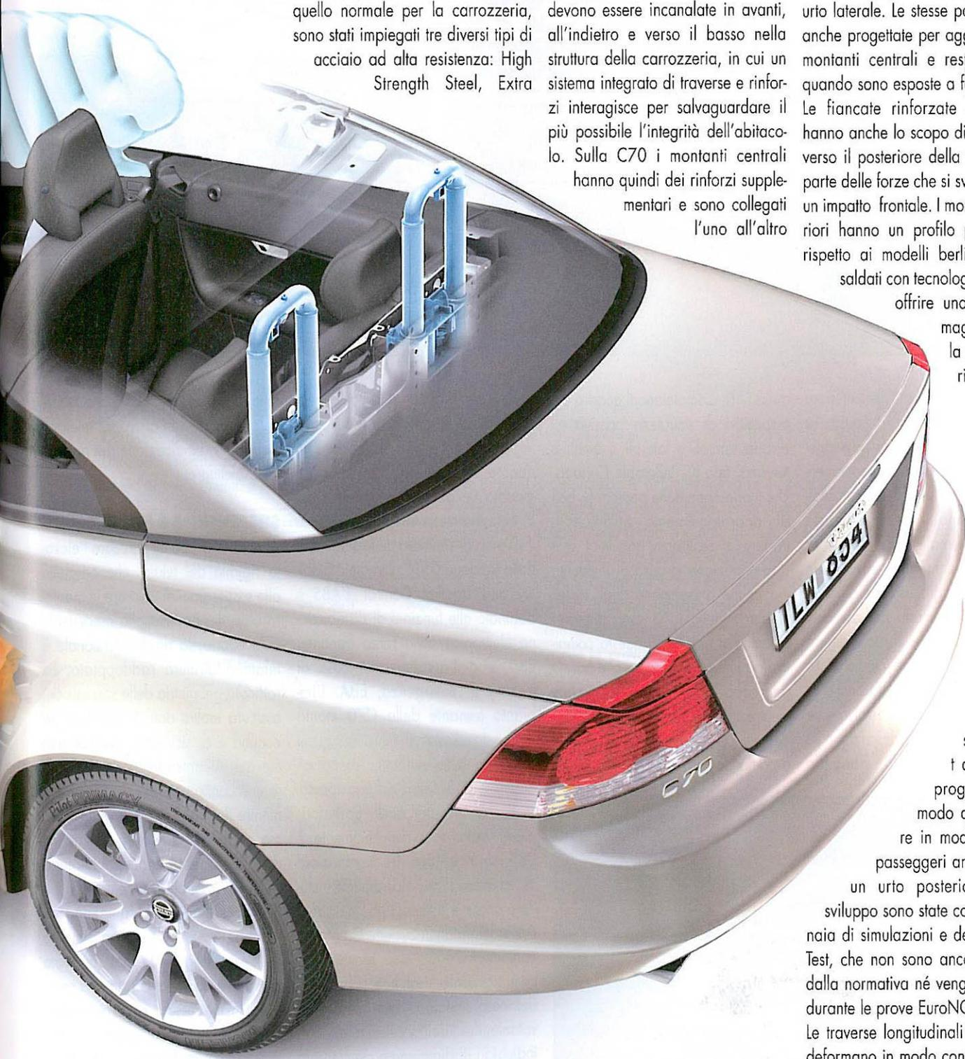
C70 è stata accuratamente progettata in modo da proteggere in modo ottimale i passeggeri anche durante un urto posteriore. Per lo sviluppo sono state condotte centinaia di simulazioni e decine di test. Test, che non sono ancora prescritti dalla normativa né vengono eseguiti durante le prove EuroNCAP. Le traverse longitudinali posteriori si deformano in modo controllato. Esse sono collegate ai montanti posteriori della carrozzeria per distribuire le
