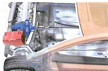
**Il motore della C70 è un 5 cilindri a disposizione trasversale. La sua realizzazione compatta è abbinata all'efficace alloggiamento di altri componenti all'interno del vano motore. In questo modo, in caso di urto frontale, si ha più spazio di deformazione.**
