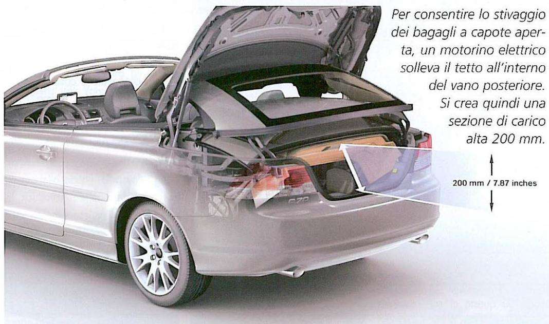
Locking, che permetterà di chiudere con il telecomando, oltre alla vettura, anche diversi vani sparsi per l'abitacolo. Parlando di spazio per gli oggetti, va citata la capienza del bagagliaio, elemento spesso critico in vetture di questo segmento. La C70 riserva 404 litri di spazio a tetto chiuso, mentre, aprendo la
