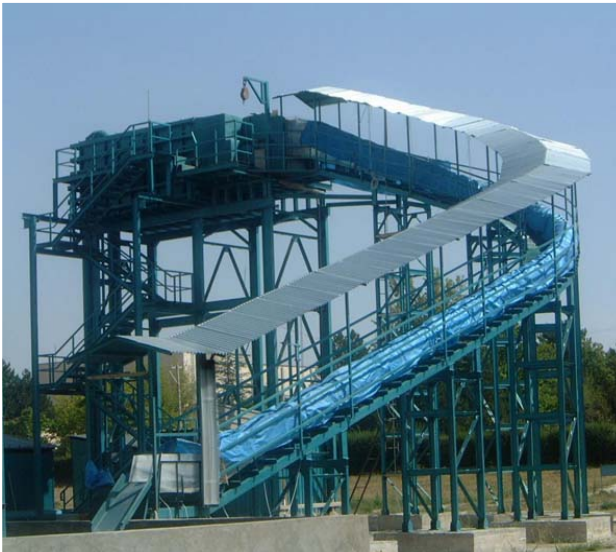
Deriner Barajı 1/20 Ölçekli Tüneli Dolusavak Modeli
