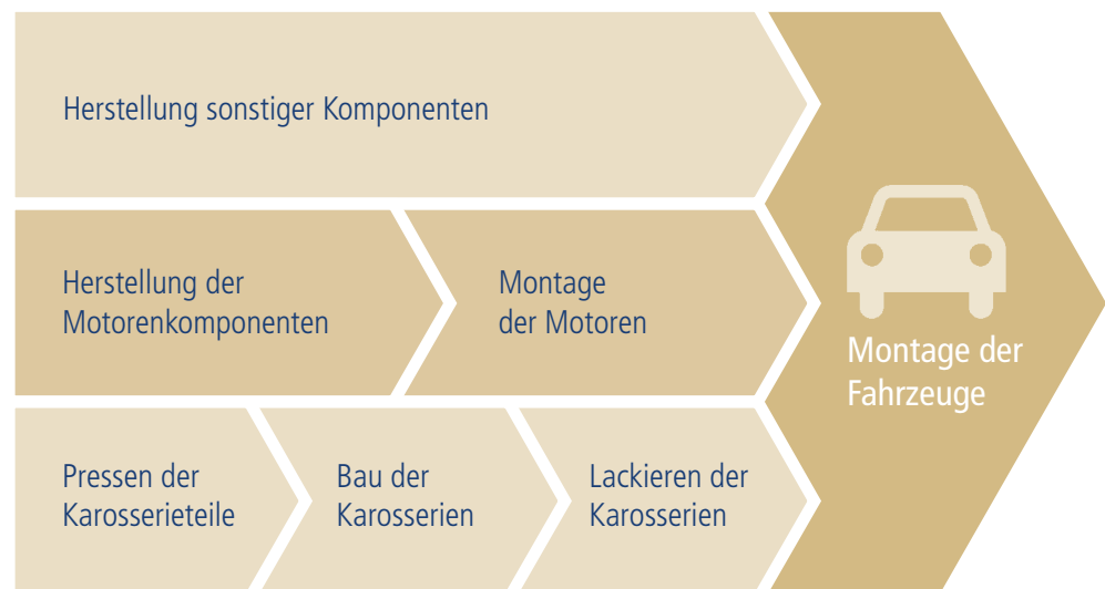
Abbildung 7: Typische Produktionsschritte eines Automobilherstellers
