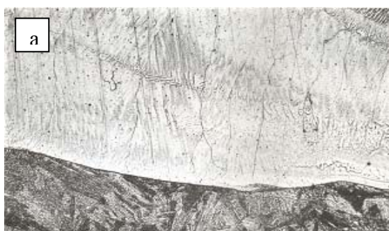
Rys. 5.1. Budowa napoin ze stali austenicyznej w stanie surowym na stali; a) niestopowej, b) austenicyznej. Dendrytyczna struktura napoin, pod napoinami zarysowana SWC. Traw. a) 10% HNO 3 , b) HNO 3 + HF
