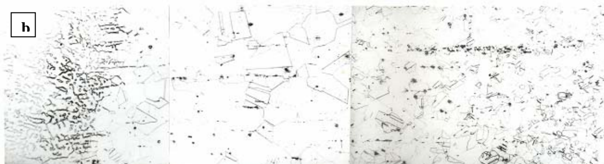
Rys. 5.2. Mikrostruktura w obszarze wtopienia napoiny za stali austenicyznej na stali; a) niestopowej, b) austenicyznej. Dendrytyczna budowa austenitu w spoinie, w SWC przegrzane, równoosiowe ziarna materiału rodzimego. Traw. HNO 3 + HF
