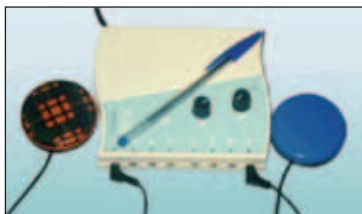
Een voorbeeld van een schakelkast met twee knoppen: hier de ICON-schakelaar ® met knoppen Jellybean ® en Liberator switch ® .
