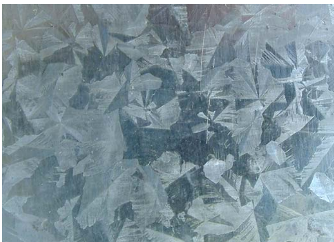
Rys. 3.4. Widok powierzchni blachy ocynkowanej z charakterystycznym „kwiatem”
