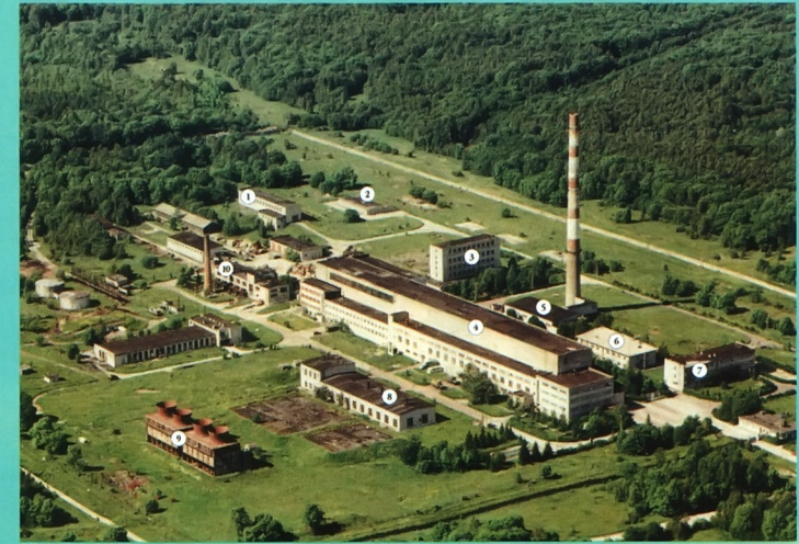
Paldiski tuumaobjekt: 1 – vedeljäätmete hoidla; 2 – tahkete jäätmete hoidla; 3 – vedeljäätmete töötlemiskompleks; 4 – peahoone, kus asusid allveelaevamaketid; 5 – ventilatsioonihooned; 6 – eripesula; 7 – laboratooriumihooned; 8 – jahutusvee pumbajaam; 9 – gradiirid (jahutid); 10 – katlamaja.
