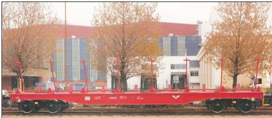
Figur 12: Vagntyp littera Slmps 953. Bilden visar tydligt låsanordningarna för sligbehållarna.
