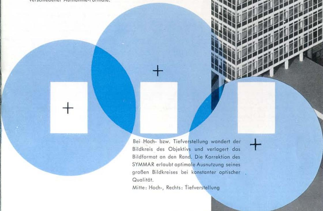
Bei Hoch- bzw. Tiefverstellung wandert der Bildkreis des Objektivs und verlagert das Bildformat an den Rand. Die Korrektur des SYMMAR erlaubt optimale Ausnutzung seines großen Bildkreises bei konstanter optischer Qualität.
