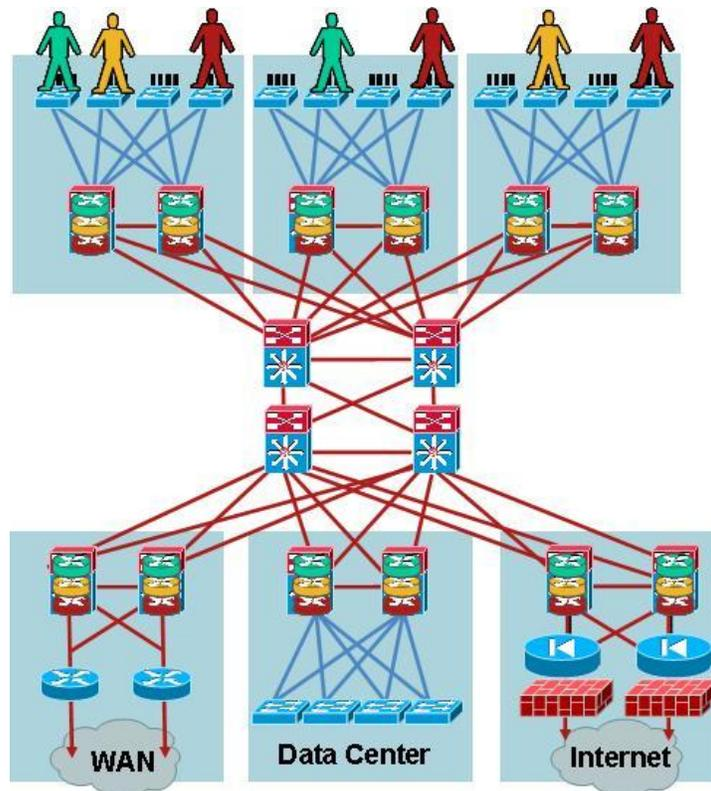
Dans ce cas, les routeurs de distribution faisant l'interconnexion entre le réseau MPLS de cœur et la périphérie peuvent être vus comme ci-dessous, d'un coté avec des interfaces 802.1Q et de l'autre des interfaces labélisées MPLS :
