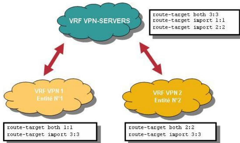
L'exemple ci-dessus montre la configuration des règles d'Import / Export permettant aux VPN1 et VPN2 d'accéder à des ressources mutualisées dans VPN-SERVERS.
