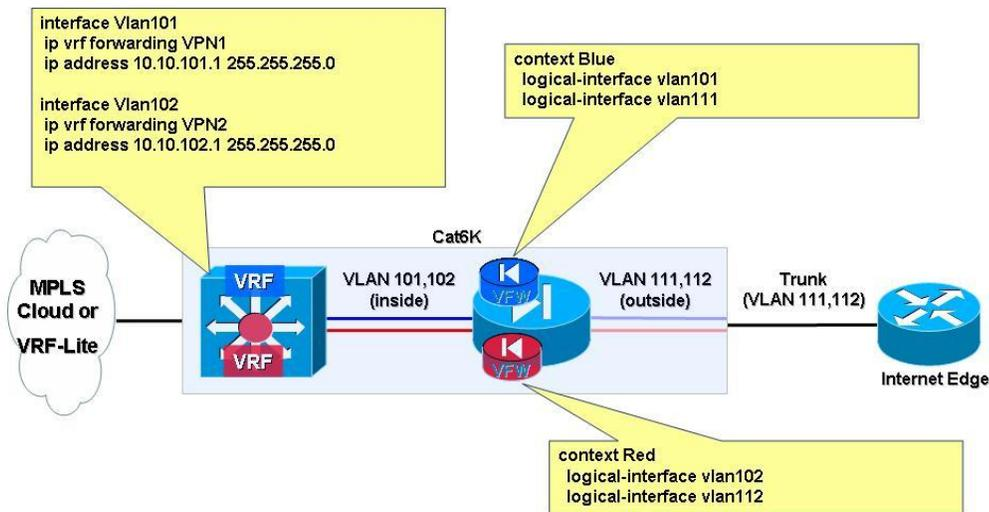
Les Firewalls Cisco permettant d'interconnecter les VRF peuvent être configurés de 2 manières différentes :
