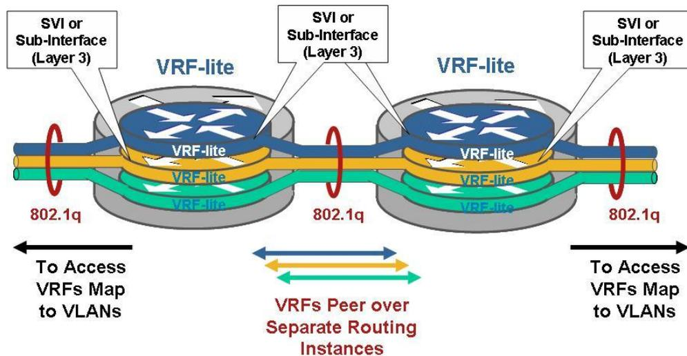
Il suffit alors de définir des sub-interfaces sous l'interface physique d'interconnexion, et d'associer ces sub-interfaces aux VRF à router sur le trunk.
