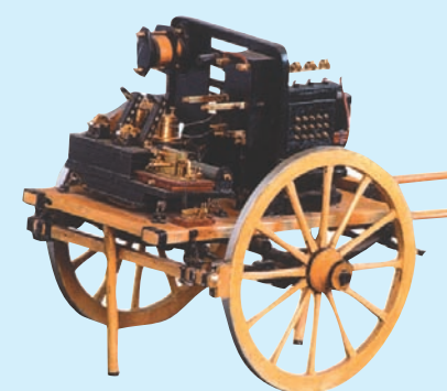
Полевая искровая радиостанция фирмы «Сименс и Гальске» (модель) 1904 г.
