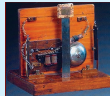
Первый приемник А.С. Попова Лабораторный образец 1895 г.
