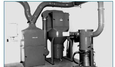
Absauganlage für Schleifstäube
