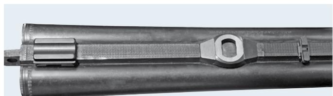
**Schritt 2:** Zunächst werden die Schieber des SEM-Schlösschens ausgebaut. Anschließend wird auf das Schlösschengehäuse die Prismenplatte aufmontiert.
