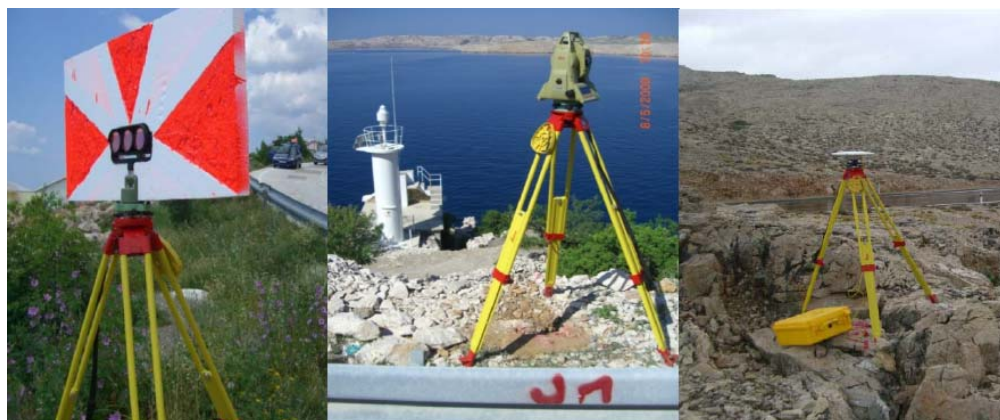
Sl. 9. Korišteni instrumentarij za GNSS i trigonometrijski nivelman
