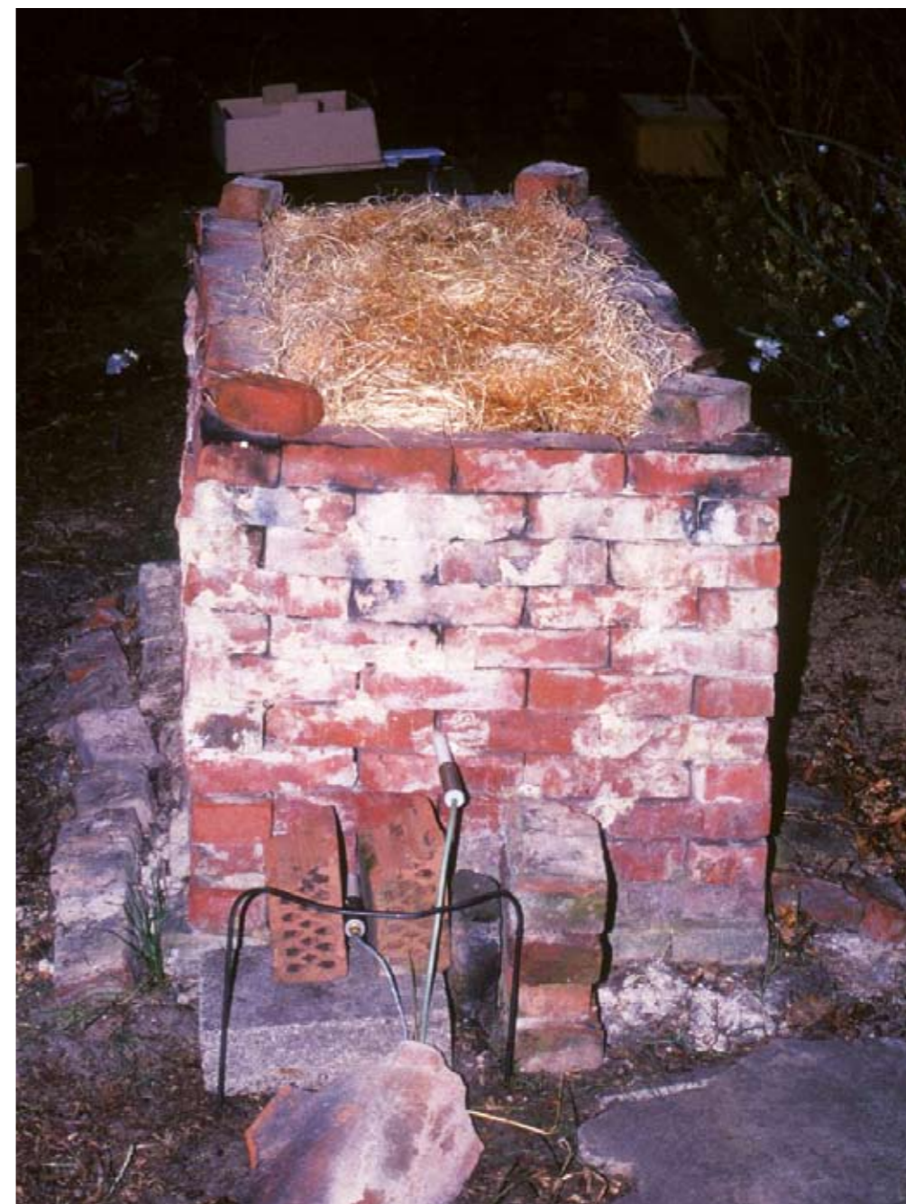
Fig. 2. Oven gebruikt voor het Black-topped experiment. De positie van de pyrometers geeft aan op welke hoogte de temperaturen gemeten werden.
