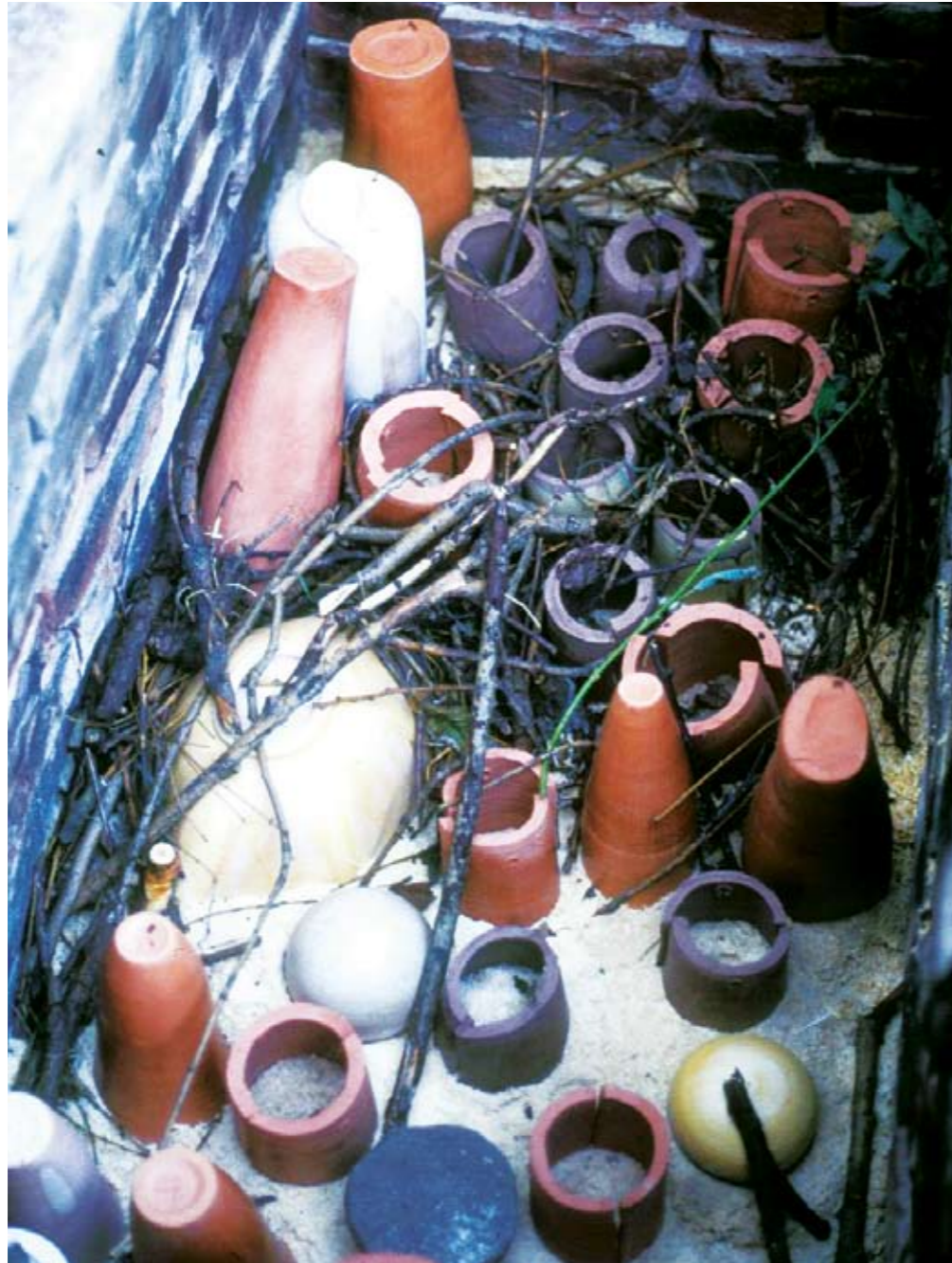
Fig. 3. Het laden van de oven. Vazen en teststukken in zaagsel geplaatst.
