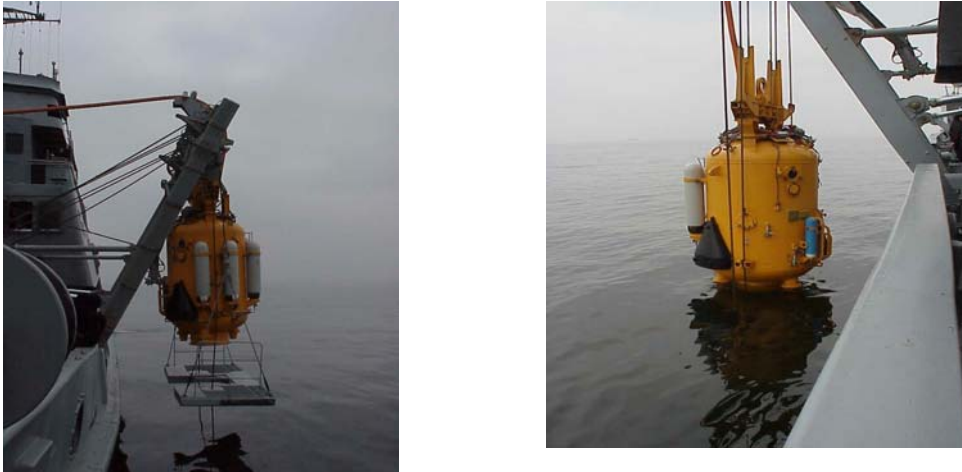
Rys. 6. Dzwon nurkowy typu otwartego.(zdjęcia własne).
