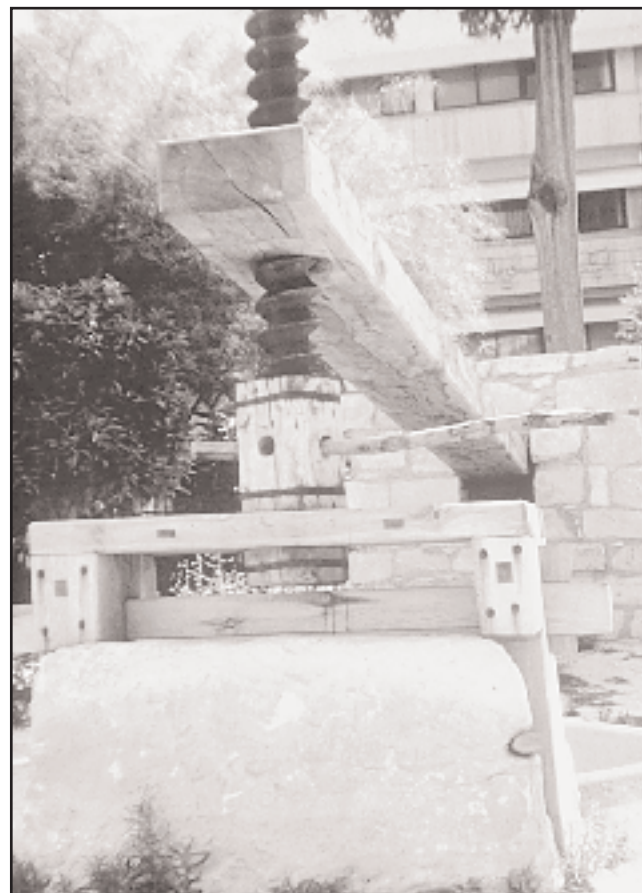
Βυζαντινό πιεστήριο από την κοιλάδα του ποταμού Κούρρη, κοντά στη Λεμεσό. Συνδυασμός μοχλού και κοχλίας.
