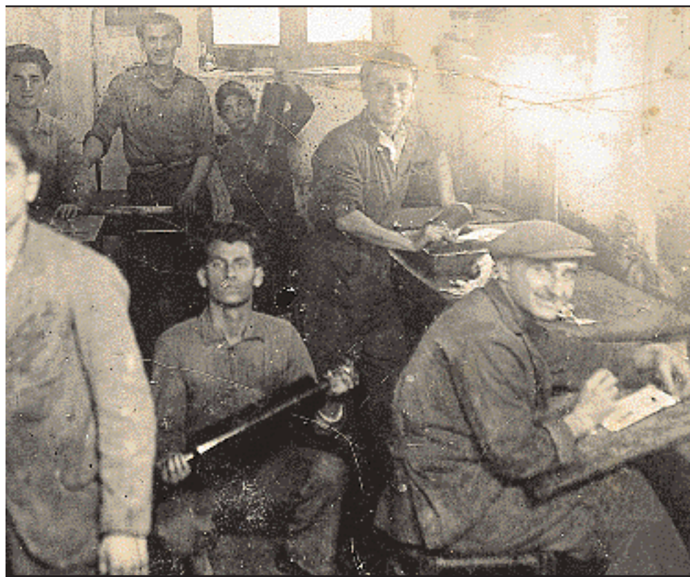
πούλου), στην Αθήνα, γύρω στο 1934. Σαφής προκύπτει ο καταμερισμός της εργασίας: αριστερά : το σχέδιο της παράστασης στο οξύ· πιο πίσω άλλοι τεχνίτες κάνουν με το χέρι τις απαραίτητες, τεχνίτης μελανώνει με κύλινδρο την πλάκα για να τυπώσει δοκίμιο της τσιγκογραφίας· τέλος, φωτογραφία παραχωρήθηκε από τον παλιό τσιγκογράφο Γεράσιμο Λάιο.)
