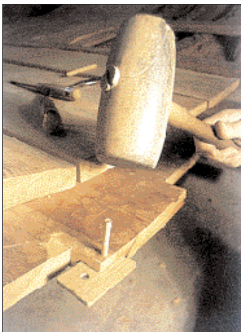
► Στο ναυάγιο των πλοίων της Κυρήνειας μετρήθηκαν 4.000 μόρια συγκεντρωμένα με 8.000 καβίλιες (ξύλο-καρφα).
