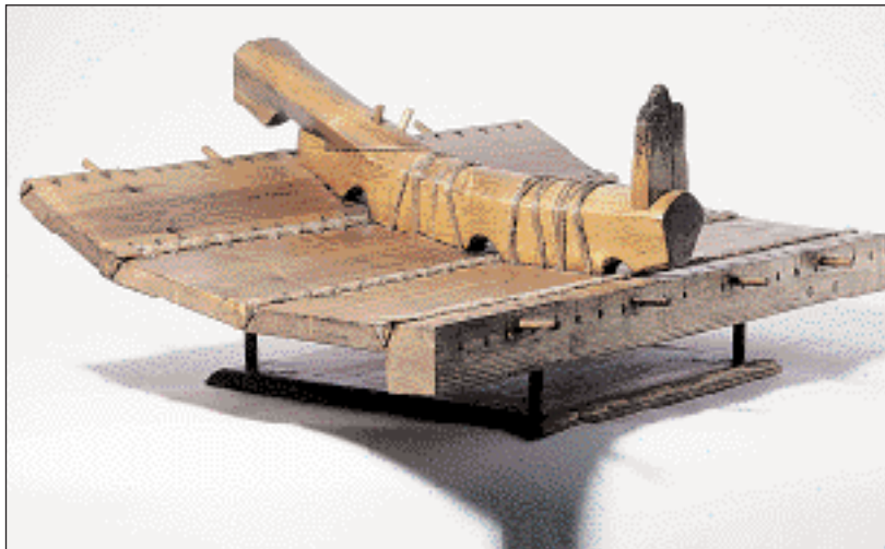
◀ Μοντέλο του τρόπου επίδεσης των αρχαϊκών πλοίων της Μασσαλίας.
