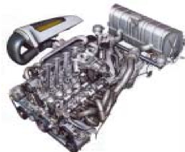
Rys. 1. Silnik Porsche V10 z doładowaniem pojedynczym przewodem dolotowym i doładowaniem rezonansowym z rezonatorem Helmholtza
