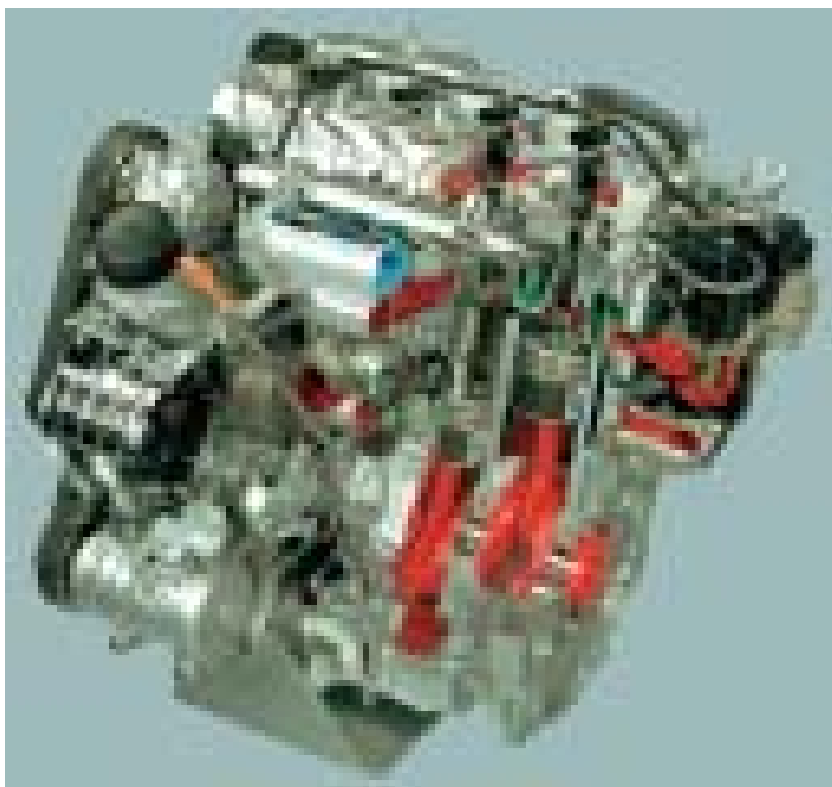
Rys. 2. Częściowy przekrój silnika i-CTDi
