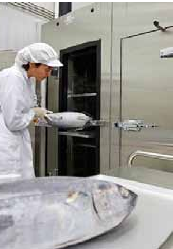
CONGELAR CON SABOR. El Centro de Investigación Marina y Alimentaria Azti-Tecnalia trabaja en el desarrollo de la congelación electromagnética en sus instalaciones de Derio (Vizcaya). Este tipo de proceso no usa la temperatura para congelar los alimentos y así conserva mejor su sabor y textura.
