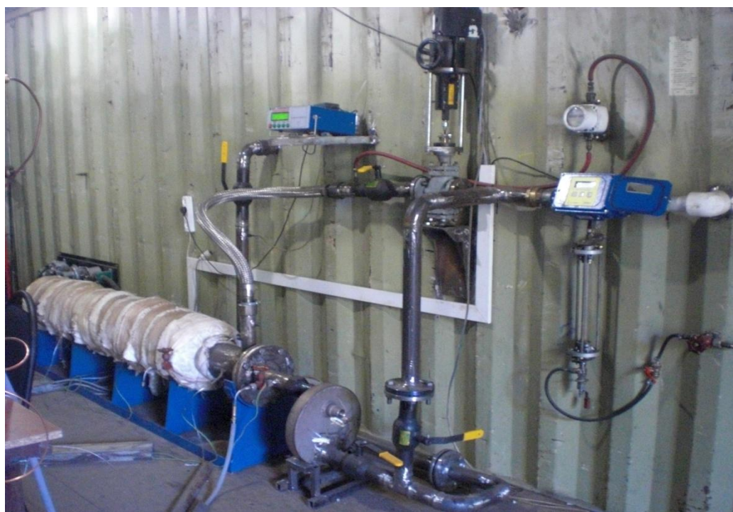
Рис. 1. Реакторный узел пилотной установки селективного окикрекинга тяжелых компонентов ПНГ с расходом газа до 25 \text{ м}^3/\text{ч} , рассчитанный на работу с двигателем мощностью до 100 кВт.
