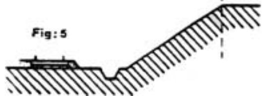
Dans le cas d'une voie posée à flanc de coteau, la limite légale à considérer est constituée par le point extrême des déblais ou remblais effectués pour la construction de la ligne et non la limite du talus naturel (figures 6 et 7).
