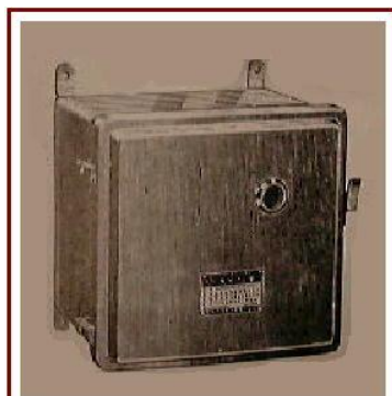
汎用型交流アーク溶接機に取り付けられた、外付け感電防止器の初期のもの。
