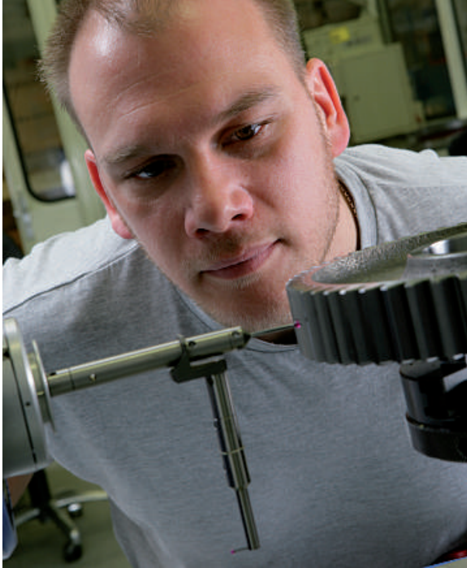
Zahnflankenmessung an einer 3D-Messmaschine
