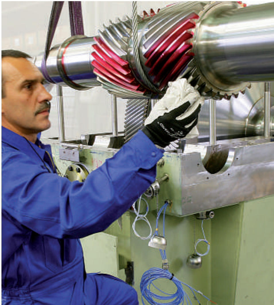
Montage eines Ritzels für ein Turbogetriebe
