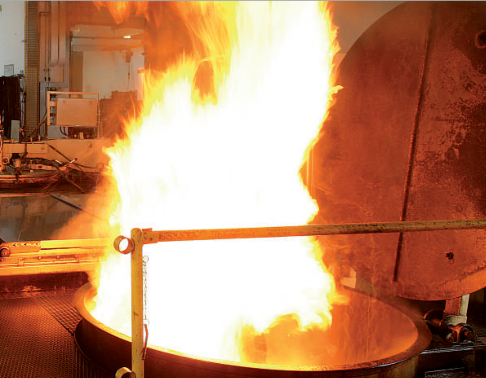
Die Zahnräder werden zum Einsatzhärten ca 60 Minuten ins Ölbad getaucht
