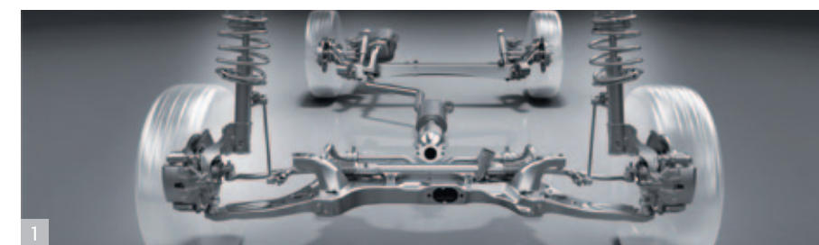
1. Подвеска Передняя стойка подвески Макферсона имеет двухканальный изолятор стойки для рассеивания ударов и вибрации, а также повышения устойчивости рулевого управления. А сдвоенная торсионная балка моста задней подвески обеспечивает устойчивость и плавность движения.
