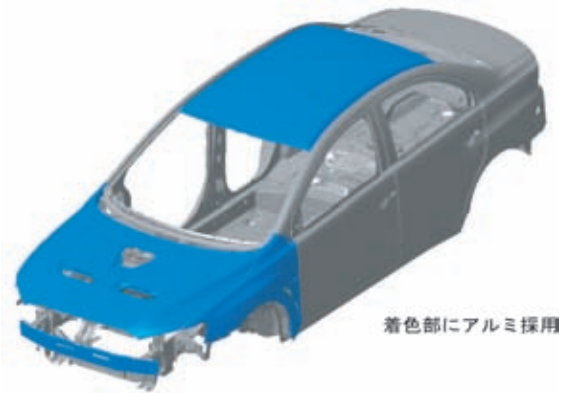
図3 アルミ採用ボデー（ランサーエボリユーション） Body incorporating aluminum (LANCER EVOLUTION X)
