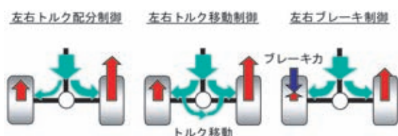
図2 直接ヨーモーメント制御方式 Various types of direct yaw moment control
