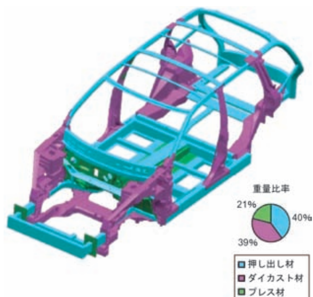
図4 アルミスペースフレームボデー Aluminum space frame body
