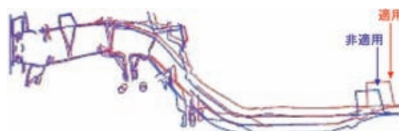
図9 サイドメンバー変形状況 (正面衝突) Side member deformation ( frontal impact)
