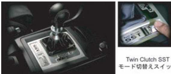
図 12 シフトパネル (ツインクラッチ SST) Shift panel (Twin clutch SST)
