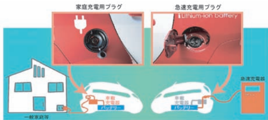
図 15 充電システム Charging systems
