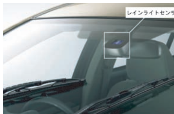
図1 レインライトセンサレイアウト Location of rain-light sensor
