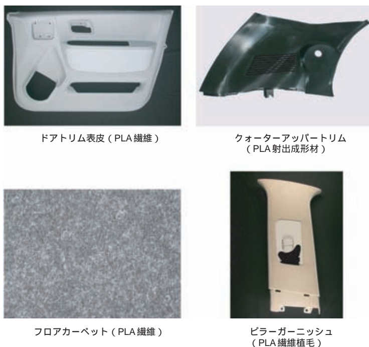
図 12 2007年フランクフルトモーターショーにおける展示部品 (PBS 竹繊維ボードと PLA 繊維フロアマットも展示) Exhibits at 2007 year Frankfurt Motor Show
