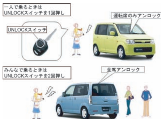
図3 運転席ドア限定アンロック Driver's door limited unlocking function
