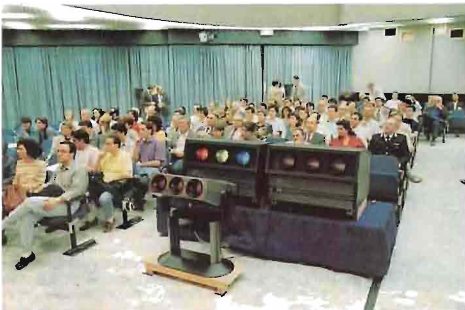
Fig. 1 — Sala visione allestita al Centro Congressi della Camera di Commercio a Perugia. Si notino, affiancati, i due proiettori per Alta Definizione (uno dei quali di scorta) ed, in primo piano, il proiettore PAL di emergenza.
