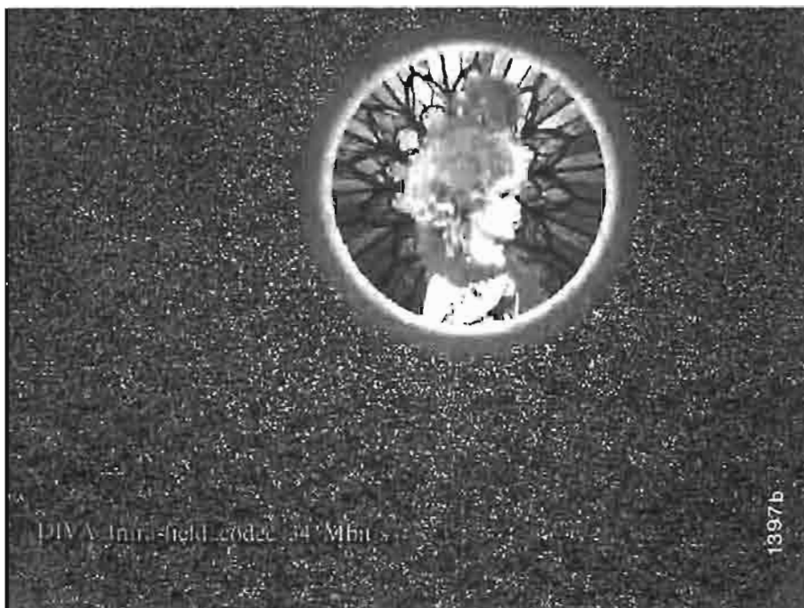
Fig. 5 — Due semiquadri ottenuti a partire dalla sequenza «Diva with noise» (realizzata da CBC, Canada e ITV, Gran Bretagna) co-decodificata mediante il sistema DCT intra-field. Si evidenzia il comportamento del codec nel caso di immagine (la prima) con forte correlazione spaziale e nel caso di immagine (la seconda) caratterizzata da bassissima ridondanza (in prevalenza rumore gaussiano bianco). Nella seconda immagine sono visibili alcuni difetti dovuti al fatto che il codificatore è costretto ad eliminare informazione che non è irrilevante dal punto di vista soggettivo: all'interno del cerchio compare la struttura dei blocchi di 8x8 pel; la struttura del rumore codificato è diversa nella parte superiore dell'immagine, quando il modo di codifica è migliore, rispetto a quella nella parte inferiore, quando il buffer di trasmissione è in condizioni di riempimento eccessivo.
