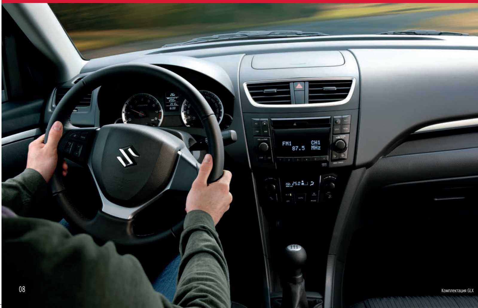
3 На фотографии изображены приборы и органы управления с включенной подсветкой
