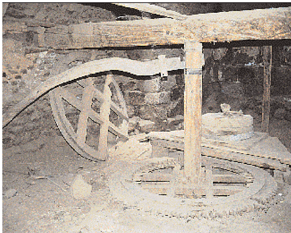
Αποψη της μηχανής αλέσεως του μεγάλου αλογόμυλου, στην ανατολική γωνία της Μονής Σινά (Φωτ.: Αρχείο Π. και Μ. Κουφοπούλου).
